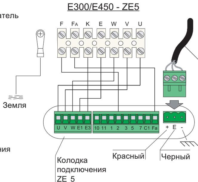
Экранированный кабель (тип 2 4 0 2 С 2 2 4 W G) для подключения кодера. При установке двух приводов используется кабель только одного из них. Если ZE5 устанавливается не на несущем профиле, максимальная длина кабеля не должна превышать 5 м.
